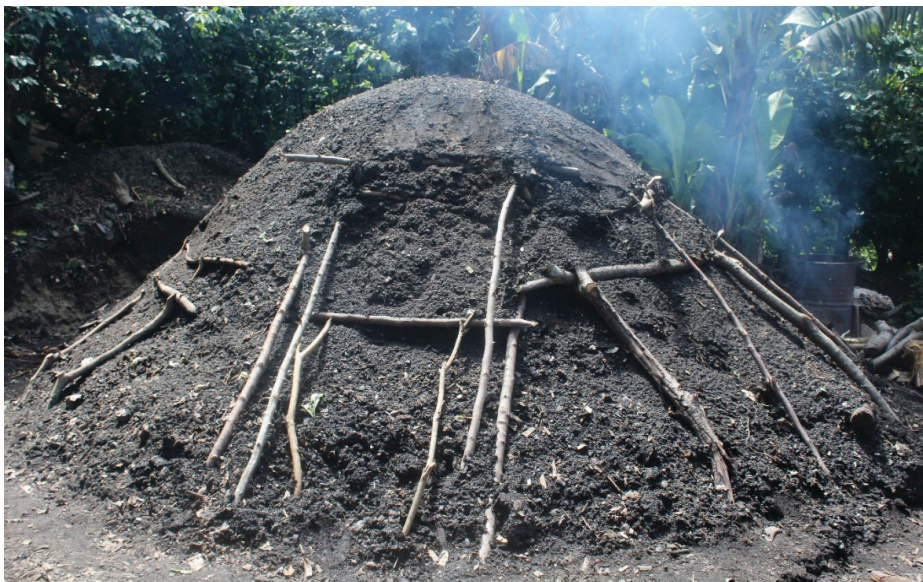
Figura 25. Parva en proceso de elaboración de carbón. (Foto propia tomada en Quezaltepeque)
