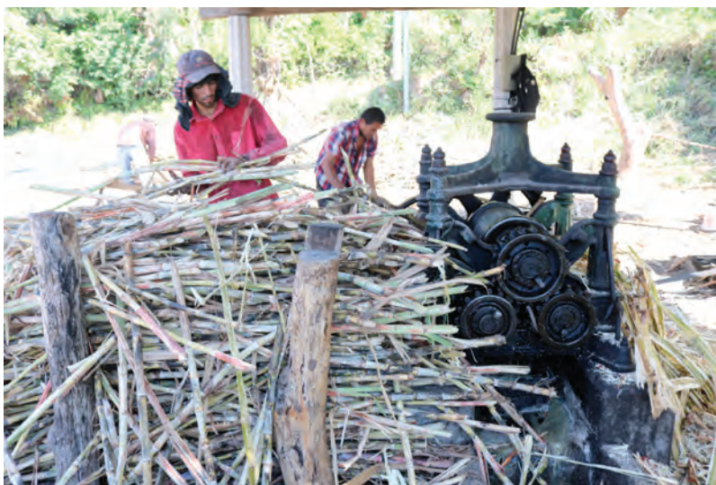
Fotografía 76. Proceso de extracción del jugo de la caña de azúcar en trapiche, utilizando motor mecánico. Fotografía tomada por Miguel Ángel Hernández Vásquez.
