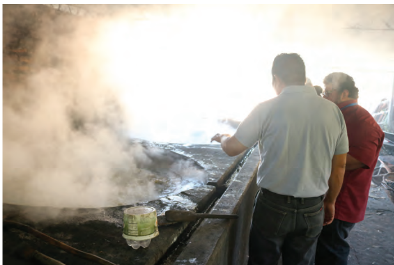
Fotografía 77. Proceso de cocción del jugo de la caña de azúcar, para obtener las diferentes variedades de dulces; en el caso particular de Santa María Ostuma, solamente se produce el dulce de panela. Miguel Ángel Hernández Vásquez.
