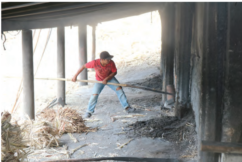
Fotografía 78. El atizador, quien se encarga de mantener el control del fuego y la temperatura del horno, quien es a su vez conocido también como hornero. Fotografía tomada por Miguel Ángel Hernández Vásquez, el día 23/11/2017
