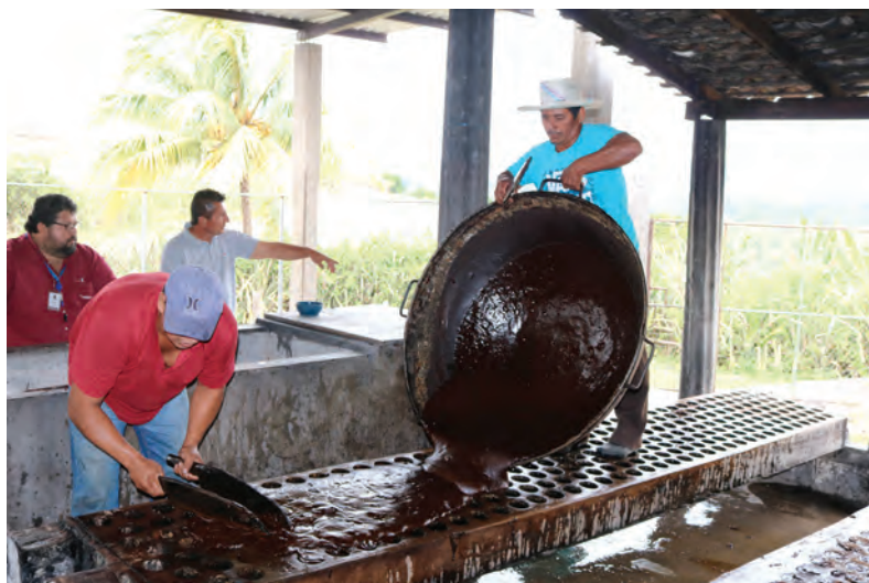
Fotografía 88. Proceso de vaciado de la mezcla batida en los moldes, diseñados para para obtener los tarros que forman el dulce de panela. Fotografía tomada por Miguel Ángel Hernández Vásquez, el día 23/11/2017.
