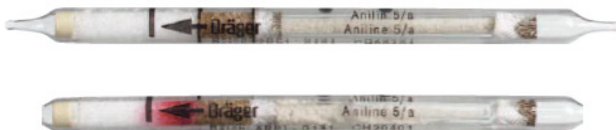
Figura 21. Tubo Dräger CH 20 401 para medir anilina 5/a en aire (Dräger, 2012)
