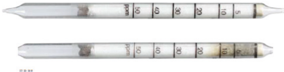
Figura 22. Tubo Dräger # 67-28-701 para medir benceno en aire
