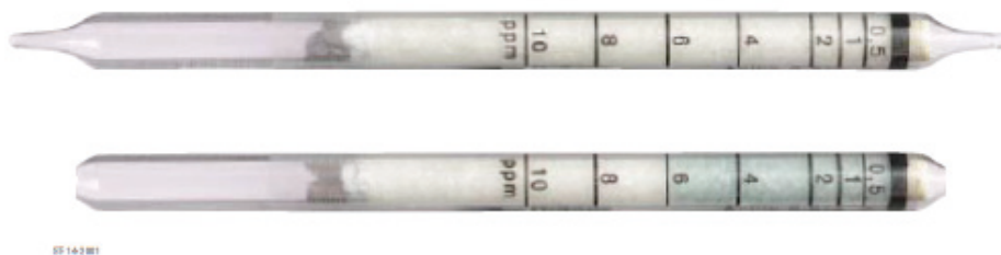
Figura 20. Tubo Dräger 67-33-171 para medir anilina en aire (Dräger, 2007)
