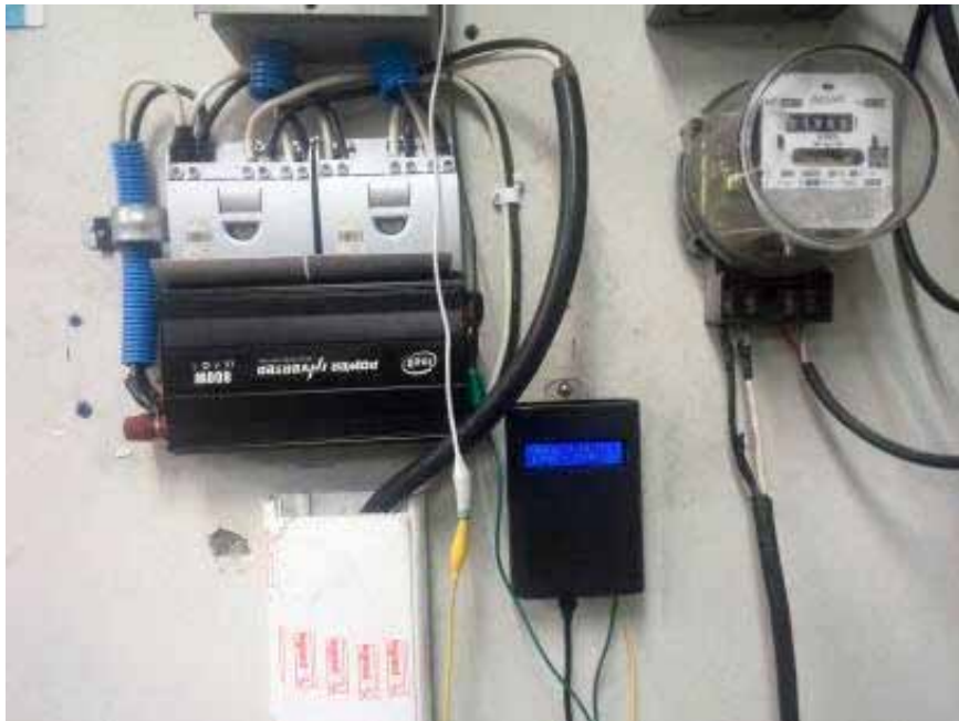
Fig. 4.3. Prototipo de monitoreo (medio) instalado junto a la acometida del panel solar(izq.)
